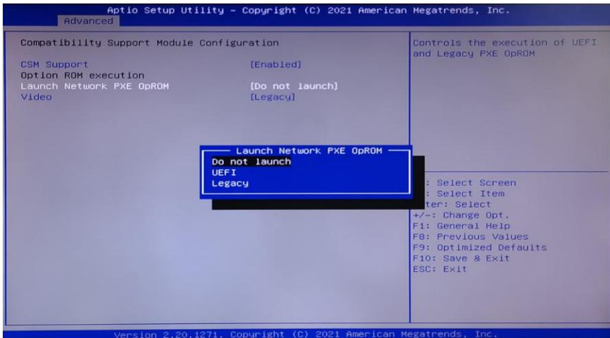
Launch Network PXE OpRom:设置无盘启动, Do not launch:关闭无盘启动, Legacy:将无盘启动模式设置为Legacy模式
