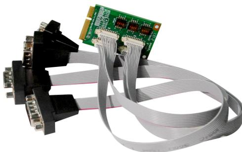
图三： TPM-4COM VER:1.0 带 COM 线
