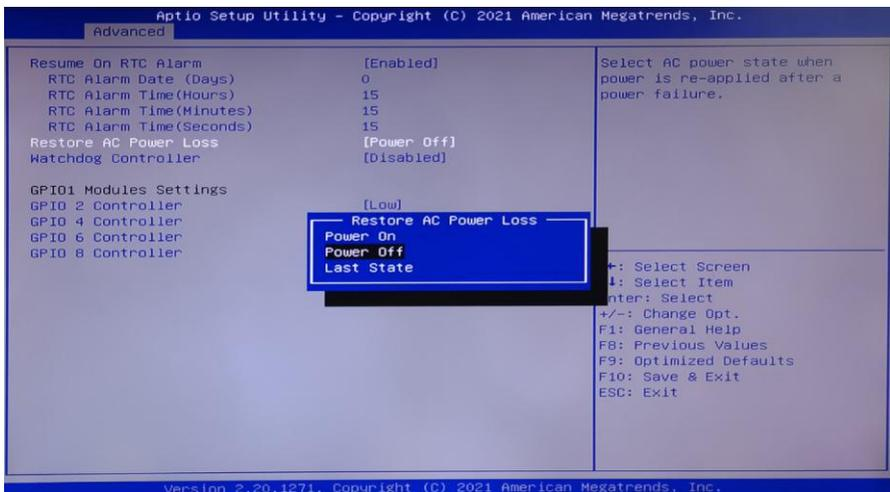
Restore AC Power Loss: 该项用于设置加电后的开机情况, 选 Power Off 则加电后需按下电源键才能开机, 选 Power On 则加电后直接开机, 选 Last State 则按照上次设
