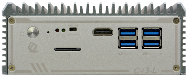
图一：C4350S-L4 前置IO图
